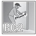
Конструктивный элемент в исполнении с защитой от взлома класса **RC 2** согласно стандарту DIN EN 1627:2011
